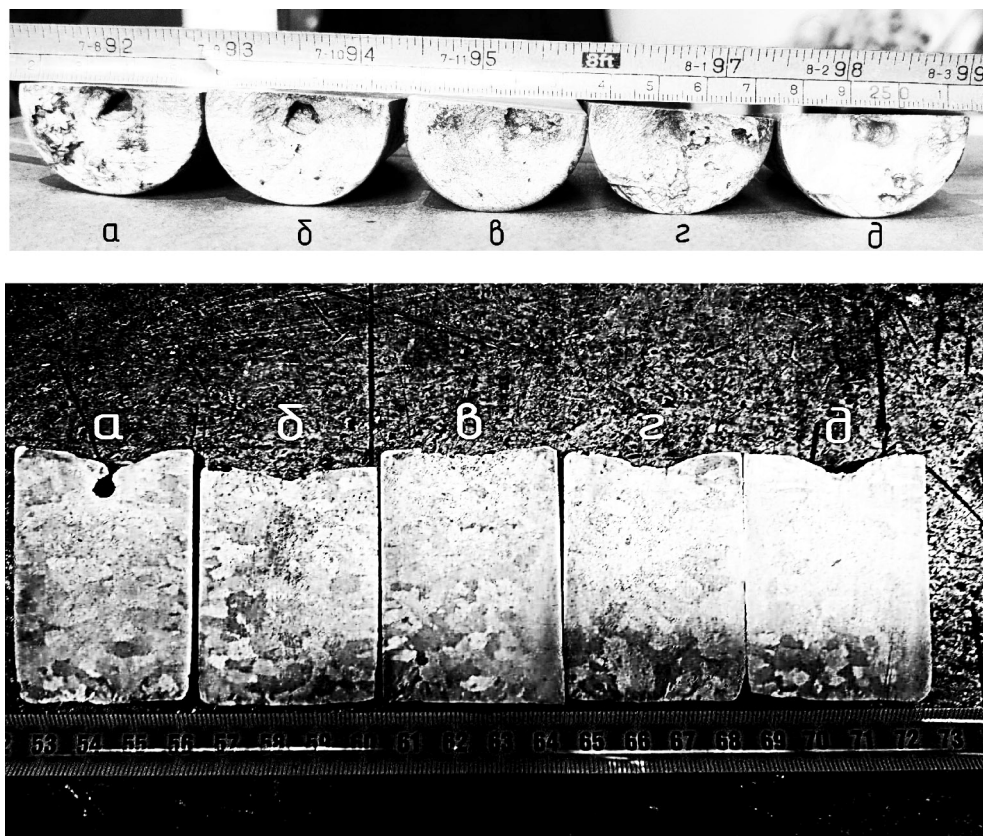
Рис. 2. Макроструктура зразків, залитих в підігріту графітову форму; а – без обробки, б – обробка 4 с, в – обробка 8 с, г – обробка 16 с, д – обробка 24 с
