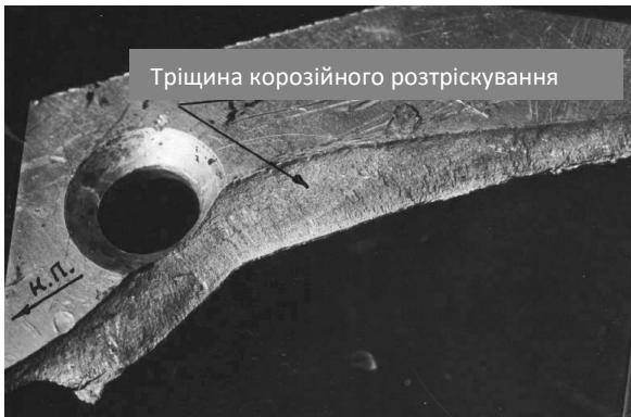
Рис. 3. Поверхнєве ушкодження панелі внаслідок виразкової корозії (а), руйнування обшивки за механізмом корозійного розтріскування (б) [4]
