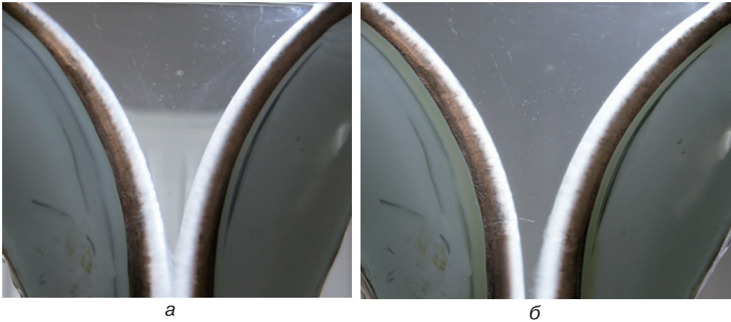
Рис. 1. Залежність товщини кірок камфена, які твердіють на поверхнях валків від гідродинаміки розплаву між ними
