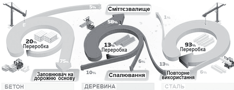
Рис. 1. Схема поточних операцій після закінчення терміну експлуатації трьох найпоширеніших будівельних матеріалів: бетону, деревини та сталі [1]
