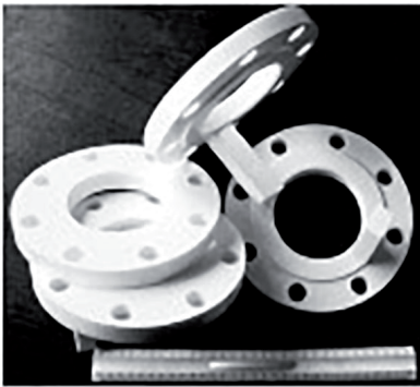
Рис. 2. Литі металовироби для будівництва і моделі з ППС: а – модель з ППС і по ній виліток крупної рами [3]; б – великий кронштейн на колоні [4]; в – кронштейн-спайдер для кріплення скляного заповнення [5]; г – плити компанії Rong Feng ( https://www.rfpccl.com , Тайвань); ППС-моделі з ливарного цеху ФТІМС: д – труби і каркасного модуля (обидва висотою близько 1,3 м); е – фланців для скріплення трубчастих каркасів; ж – декоративної опори під колону
