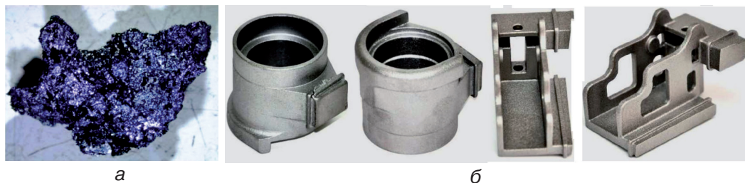
Рис. 2. Зольний залишок (а) та виливки, отримані з використанням випалюваних FDM-моделей (б) [8]
