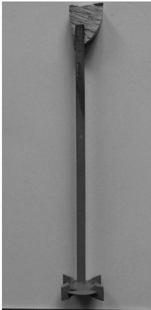
Рис. 2. Загальний вигляд турбінної мішалки, яку використовували в новому технологічному процесі реолиття сплаву АК7ч для механічного перемішування металевої суспензії в утепленому "кармані" секційного жолоба
