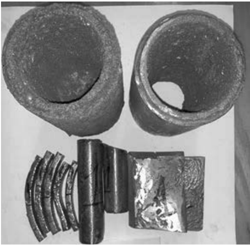
Рис. 6. Ескіз (а) та фасонні виливки (б) з експериментального сплаву ФС15л*
