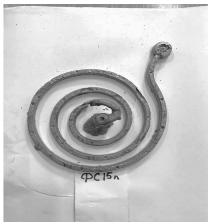
Рис. 7. Спіральні проба для визначення рідкоплинності сплаву ФС15л
