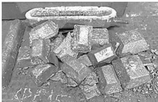
Рис. 5. Одержані злитки прототипу сплаву ФС15л для подальшого використання як коригувальних присадок у подальших плавках
