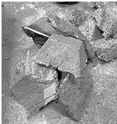
Рис. 3. Одержані злитки рафінованого за вмістом сірки переробного чавуну для включення до складу металошихти експериментальних плавок
