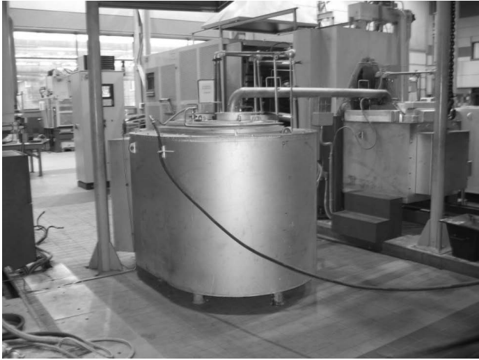
Рис. 1. Загальний вигляд комплексу обладнання для лиття під тиском магнієвих сплавів на базі машини CP MGH 400 з гарячою камерою пресування
