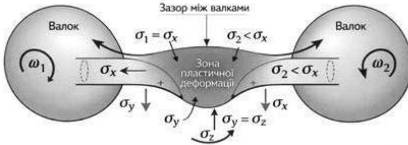
Рис. 1. Розподіл напружень у зазорі між валками (зона деформації) \sigma_x — напруження у напрямку прокати; \sigma_y — поперечне напруження; \sigma_z — напруження за товщиною; \sigma_1 — напруження на вході в зону деформації; \sigma_2 — напруження на виході із зони деформації
