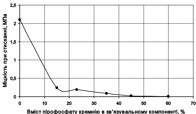
Рис. 5. Залежність міцності суміші від кількості в її складі попередньо синтезованого пірофосфату кремнію
