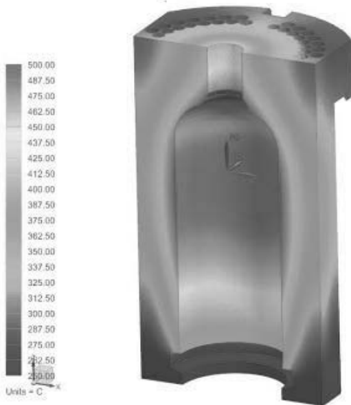
Рис. 1. Приклад розподілу температурних полів у чистовій формі [1]
