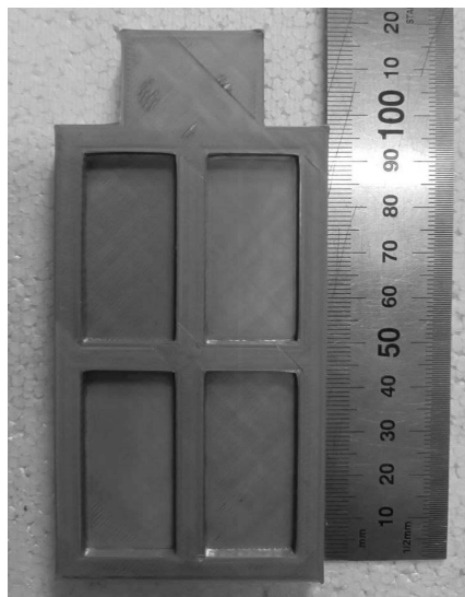
Рис. 1. Модель для виготовлення плоских зразків кераміки
