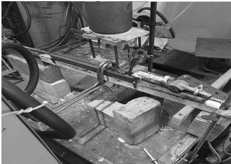
Рис. 2. Фото лабораторної установки отримання біметалічної конструкції під дією лазерного випромінювання та індукційного нагрівання
