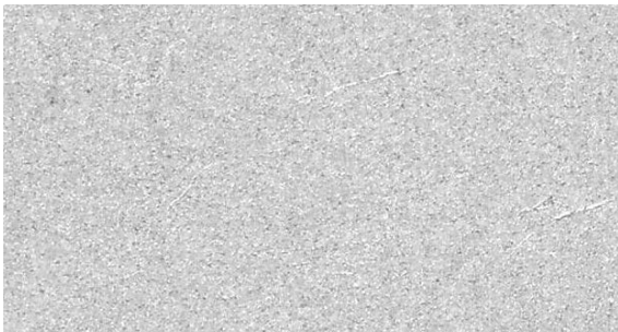
Рис. 4. Макроструктура алюмінію А7, модифікованого 2 %ZrF 4 та 4% LiF в литому стані ×100
