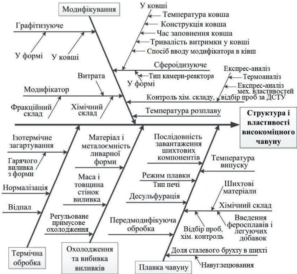
Рис. 3. Діаграма Ішікави для процесу виробництва виливків із ВЧ
