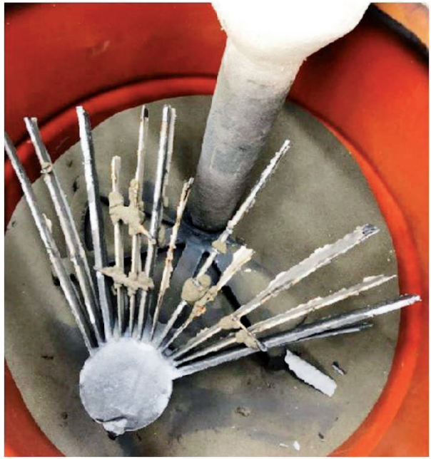
Рис. 1. Виливок із пробами за ЛГМ-процесом перед видаленням покриття
