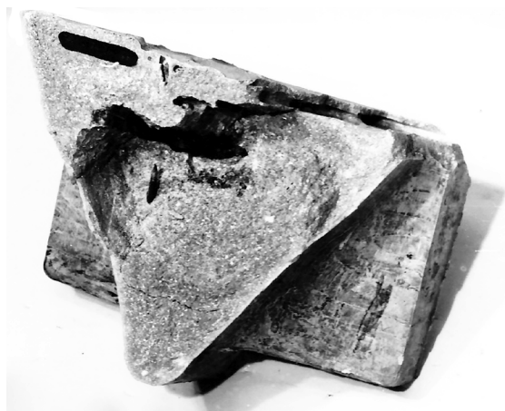
Рис. 4. Структура матеріалу та розташування усадкових раковин
