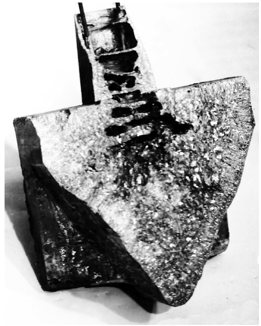
Рис. 5. Структура матеріалу та розташування усадкових раковин
