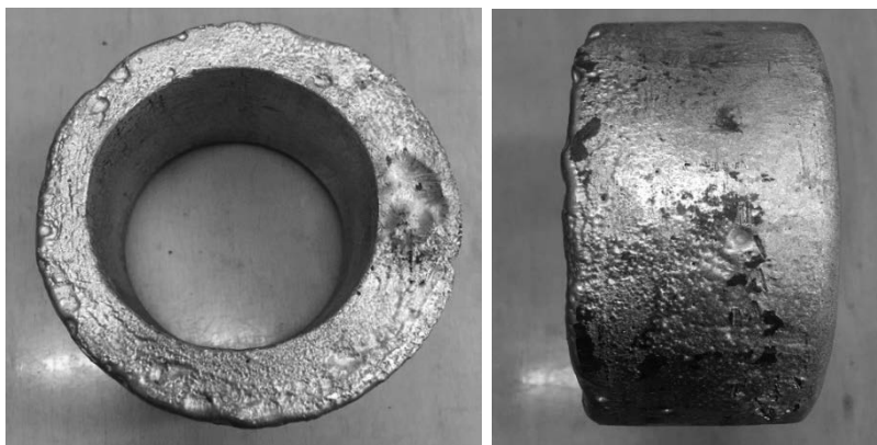
Рис. 2. Фото кільцевих проб, покритих фарбою на основі цирконію
