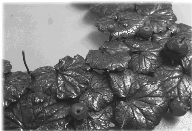
Рис. 14. Полировка и штифтовая закрепка декоративных элементов
