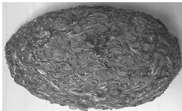
Рис. 3. Обрезанная от питателя отливка
