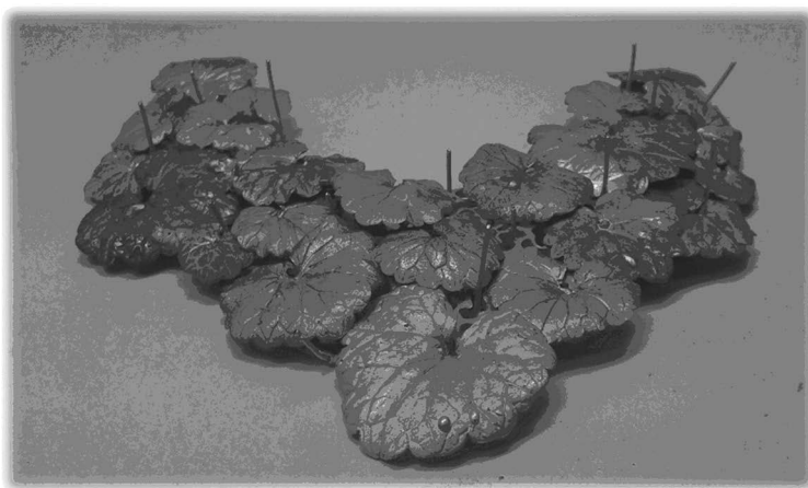
Рис. 12. Обработка изделия + пайка штифтов под закрепку
