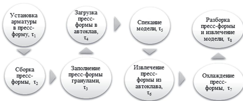
Рис. 1. Цикл изготовление пенополистироловых моделей с армирующими элементами
