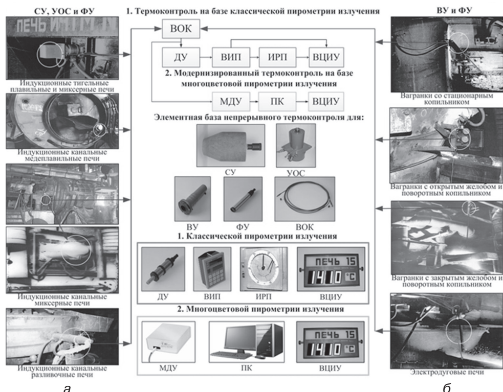
Рис. 7. Непрерывный световодный (а) и бесконтактный (б) контроль температуры расплавов в металлургических печах на базе классической и симметрично-волновой пирометрии излучения: СУ – световодное устройство; УОС – устройство оптического сочленения; ВУ – визирное устройство; ФУ – фокусирующее устройство; ДУ – детектирующее устройство; ВОК – волоконно-оптический кабель; ВИП – вторичный измерительный преобразователь; ИРП – измерительный регистрирующий преобразователь; ВЦИУ – выносное цифровое индикаторное устройство; МДУ – многоцветовое детектирующее устройство; ПК – персональный компьютер
